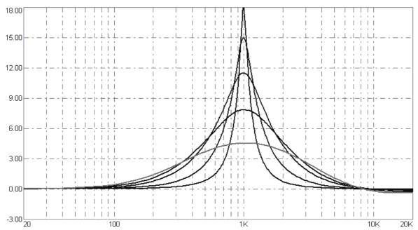
Эта зависимость установлена таким образом, чтобы сохранить по возможности наиболее постоянной площадь подинтегральной кривой АЧХ фильтра эквалайзера.
