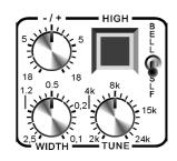
В нижнем же положении этого тумблера - включается уже режим **Shelf**, при котором функционирование этой полосы эквалайзера принципиальным образом изменяется.
