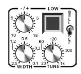
В нижнем же положении этого тумблера - включается режим **Shelf**, при котором функционирование этой полосы эквалайзера принципиальным образом изменяется.
