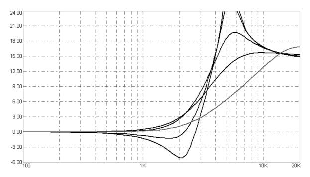
Так как данный режим также, как и ранее рассмотренный, является весьма широкополосным, и с возможностью установки дополнительного подъёма на частоте настройки, то максимальная величина изменения положения "полки" на АЧХ сделана несколько меньшей, чем в режиме **Bell**, и ограничена величиной +15dB.
